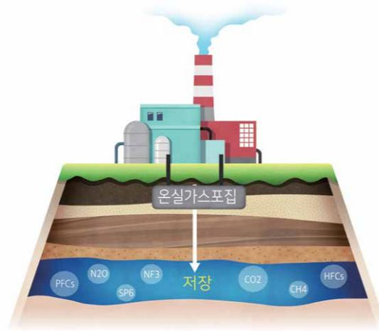
온실가스를 줄이기 위해서는 온실가스를 고정할 수 있는 기술이 필요합니다. 이산화탄소 고정화 기술은 일반적으로 이산화탄소 포집·전환·저장기술(Carbon Capture, Utilization, and Storage, CCUS)기술로 통칭합니다. CCUS 기술은 화력발전소, 철강, 시멘트 공장 및 석유화학 공장 등 화석연료의 연소 및 특정 공정 중 발생하는 CO<sub>2</sub> 배출원로부터 이산화탄소를 포집한 후 수송해, 지하의 안전한 지층에 저장하여 대기로부터 격리하는 기술로 정의되었습니다. 그러나 최근에는 포집한 CO<sub>2</sub>를 석유나 천연가스의 회수증진에 활용하거나, 화학적 혹은 생물학적인 방법을 이용해 CO<sub>2</sub>를 고분자나 액체연료 등의 유용한 물질로 전환하는 재활용적 격리기술까지 포함합니다.
