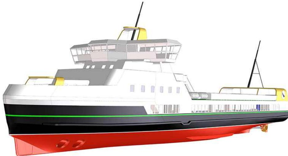
위의 e-Ferry 프로젝트 이외에도 덴마크에서는 환경 친화적인 여객선을 개발하기 위한 다른 노력이 진행 중이다. 2013년에 코펜하겐에 본사를 둔 Scandlines는 선박에 탑재된 배터리에 에너지를 저장하는 하이브리드 시스템을 대규모로 사용하는 세계 최초의 해운 회사가 되었다. 이 하이브리드 시스템을 사용하면, 엔진에 디젤 발전기가 공급할 수 있는 것보다 더 많은 에너지가 필요할 때 배터리의 에너지를 사용하고 에너지가 덜 필요할 때 초과 에너지를 배터리에 저장함으로써 엔진의 성능을 최적화하고 최대의 연료 효율을 보장할 수 있다. 이 신기술을 통해 여객선의 이산화탄소 배출량을 최대 15 %까지 감소시킬 수 있다. Scandlines사는 자사의 여객선을 100% 배터리 작동으로 단계적으로 대체할 계획인 Zero Emission Project를 계획하고 있다.
